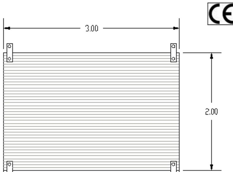
Chaque panneau de 3,00 x 2,00 est fabriqué à partir de 10 pièces en aluminium dont une femelle et mâle à chaque extrémité pour l'assemblage.
